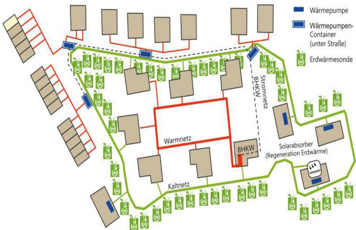
**Abb. 4.6:** Schema einer Systemlösung zur Wärmeversorgung [vgl. 4.10]
